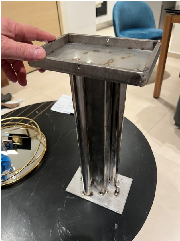
Neue Maststütze Aus V2A
